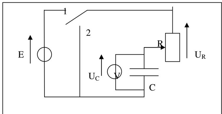
Relevé de mesures : lorsque le circuit est réalisé et que le condensateur est complètement déchargé, placer l'interrupteur en position 1 au temps  $t = 0\text{s}$ . Toutes les 10 secondes, relever la valeur de la tension  $U_C$  en Volts aux bornes du condensateur. Tracer la courbe représentant  $U_C$  en fonction du temps sur Regressi et/ou sur papier.
