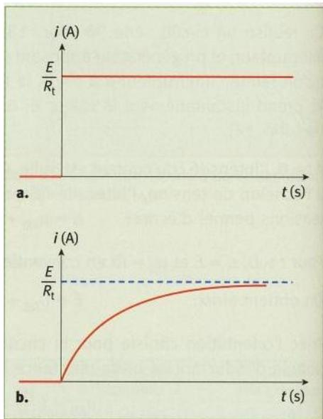
**Doc. 15.** Évolution de l'intensité du courant à la fermeture d'un circuit sans bobine (a), et à la fermeture d'un circuit RL (b).
