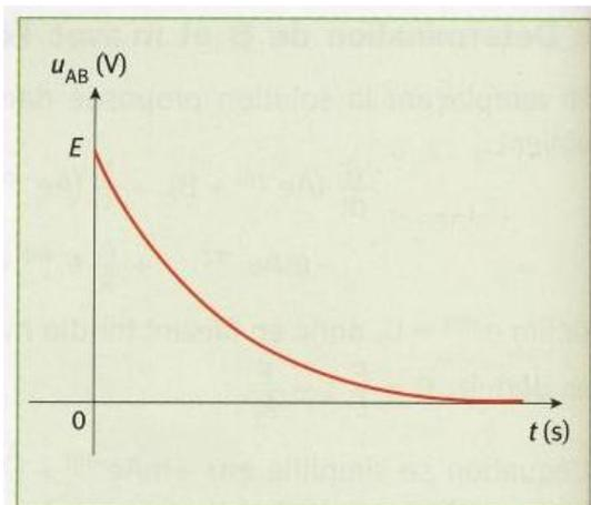
**Doc. 16.** Représentation de la tension aux bornes d'une bobine idéale ( $r = 0$ ) lors de la fermeture du circuit.
