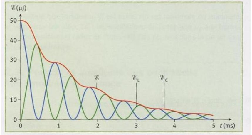
Evolution au cours du temps de l'énergie totale  $\xi$  du circuit RLC, de l'énergie  $\xi_C$  et de l'énergie  $\xi_L$  dans le cas d'oscillations amorties
