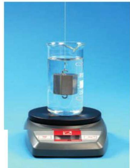
Fig. 4 Objet immergé dans l'eau d'un bécher posé sur une balance.
