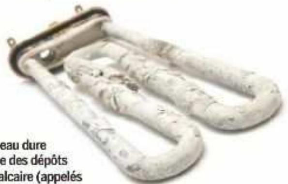
Une eau dure laisse des dépôts de calcaire (appelés tartre) sur les résistances des machines à laver.
