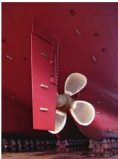
**Fig. 2** Coque de navire en acier et blocs de zinc.
