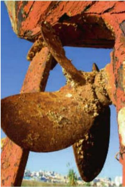
**Fig. 1** Coque de navire et hélice corrodées
